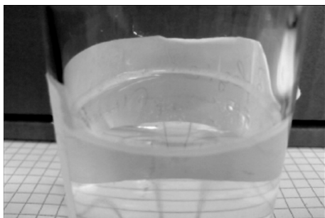
Skumdannelse filter i orden: sværet tynt skumring på kanten, faller raskt sammen.
